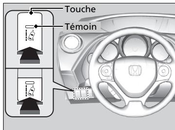
Appuyer sur la touche du système d'alerte de franchissement de ligne pour activer et désactiver le système.
