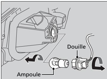
4. Tourner la douille vers la gauche et la déposer.
