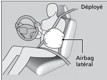
Lorsque les capteurs détectent un impact latéral modéré à sévère, le module de commande envoie un signal pour déployer instantanément l'airbag latéral du côté où s'est produit l'impact.
