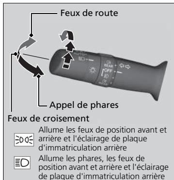
Le commutateur d'éclairage allume et éteint les feux quelle que soit la position du contacteur d'allumage<sup>\*1</sup>.
