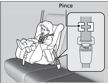
3. Pincer fermement la ceinture au niveau de la languette de blocage. Pincer les deux parties de la sangle de manière qu'elles ne glissent pas dans la languette de blocage. Déboucler la ceinture de sécurité.
