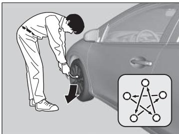
5. Abaisser le véhicule au sol et déposer le cric. Serrer les boulons de roue dans l'ordre indiqué sur l'illustration. Serrer successivement chaque boulon dans cet ordre deux à trois fois.
