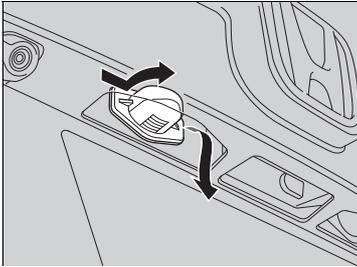
1. Pousser le bord gauche du verre vers la droite et dégager l'ensemble d'éclairage pour déposer l'ensemble d'éclairage de plaque d'immatriculation arrière.
