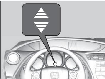
S'allument lorsque le véhicule est en mode de changement de vitesse séquentiel pour indiquer quand il faut changer de vitesse pour minimiser la consommation de carburant.
