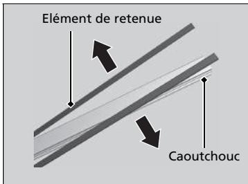
3. Déposer les éléments de retenue du balai d'essuie-glace et les monter sur un balai en caoutchouc neuf.
