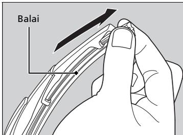
2. Déposer le balai d'essuie-glace de l'extrémité crantée en le faisant coulisser.
