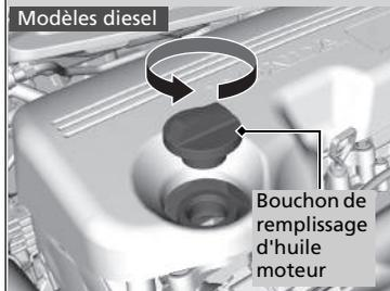
1. Dévisser et retirer le bouchon de remplissage d'huile moteur.
