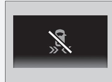
S'allume en orange si les coins du pare-chocs arrière sont recouvert de neige, de boue, etc. Le système est provisoirement suspendu. Retirer les débris des coins du pare-chocs arrière.
