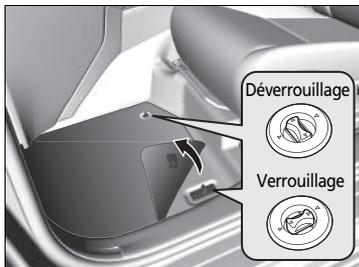
Les tapis de sol avant sont accrochés aux dispositifs d'ancrage de plancher, ce qui les empêche de glisser vers l'avant. Pour déposer un tapis de sol afin de le nettoyer, tourner les boutons d'ancrage dans la position déverrouillage. Pour la repose après le nettoyage, tourner les boutons d'ancrage dans la position verrouillage.
