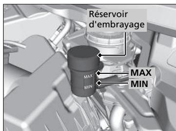
Le niveau du liquide doit se situer entre les repères **MIN** et **MAX** indiqués sur le côté du réservoir.
