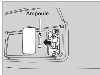
2. Déposer l'ampoule à remplacer et insérer la neuve.
