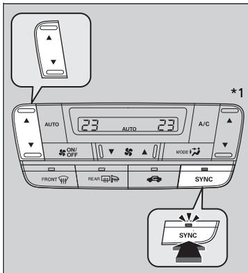
Il est possible de régler en même temps la température du côté conducteur et du côté passager en mode synchronisé.
