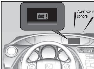
Le signal sonore retentit et un avertissement CTBA clignote sur l'écran multi-informations ; le système freine brusquement lorsqu'une collision semble inévitable.
