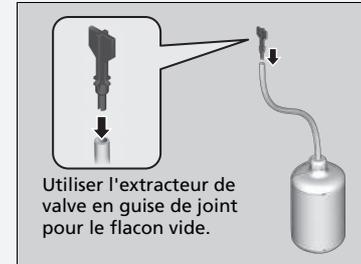
Après avoir injecté l'enduit d'étanchéité, conserver le flacon vide. Le flacon d'enduit d'étanchéité sera utilisé ultérieurement par un professionnel pour recueillir l'enduit d'étanchéité injecté.
