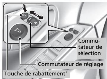
Il est possible de régler les rétroviseurs extérieurs lorsque le contacteur d'allumage est sur MARCHE
