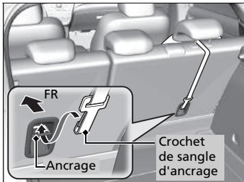
► Installation d'un dispositif de retenue pour enfant compatible avec les ancrages inférieurs
