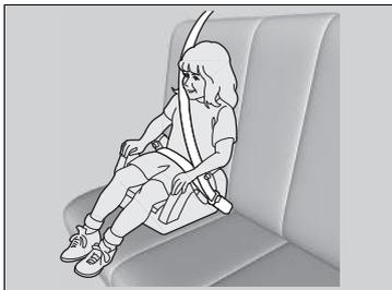
Si l'utilisation d'une ceinture ventrale/thoracique ne convient pas, placer l'enfant dans un siège rehausseur sur l'un des sièges arrière. Pour la sécurité de l'enfant, s'assurer que l'enfant satisfait à l'ensemble des conditions du fabricant du siège rehausseur.
