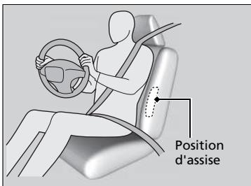
Les airbags latéraux sont logés dans le flanc extérieur du dossier de siège conducteur ou passager avant.
