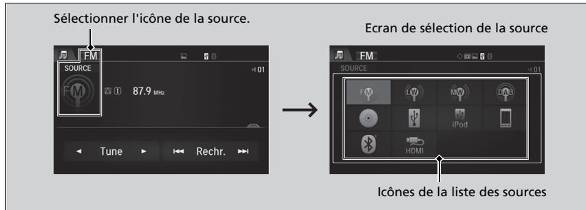
Sélectionner l'icône de la source actuelle, puis sélectionner une icône sur la liste des sources pour basculer sur cette source audio.
