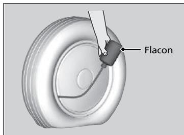
7. Retourner le flacon, puis injecter la totalité de l'enduit d'étanchéité.
