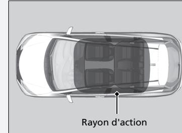
Il est possible de mettre le moteur en marche lorsque la télécommande d'accès sans clé est à l'intérieur du véhicule. Le moteur peut aussi fonctionner si la télécommande d'accès sans clé est près d'une porte ou d'une vitre, même à l'extérieur du véhicule.
