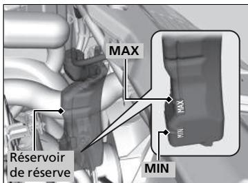
1. Vérifier la quantité du liquide de refroidissement dans le réservoir de réserve.
