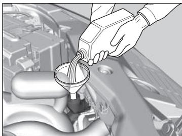
2. Si le niveau du liquide de refroidissement est inférieur au repère **MIN**, ajouter du liquide de refroidissement spécifié jusqu'au repère **MAX**.
