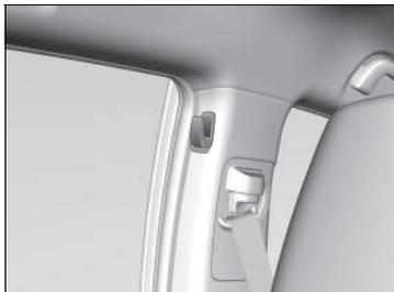
Des crochets porte-manteau sont montés sur les montants de porte gauche et droite.
