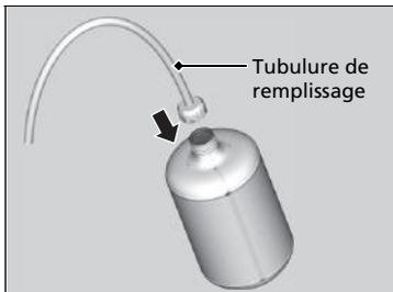
2. Visser la tubulure de remplissage sur le flacon.
