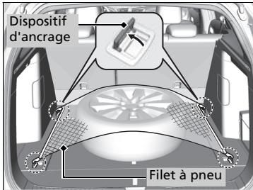
1. Ouvrir la trappe de plancher du compartiment à bagages. S'assurer qu'il se trouve au niveau du plancher principal.
