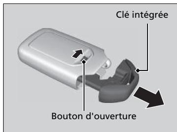
La clé intégrée peut être utilisée pour verrouiller/déverrouiller les portes et le hayon lorsque la batterie de la télécommande d'accès sans clé est déchargée et que le verrouillage/déverrouillage centralisé des portes est désactivé. Pour retirer la clé intégrée, l'extraire en faisant coulisser le bouton d'ouverture. Pour remettre la clé intégrée, l'enfoncer dans la télécommande jusqu'à ce qu'elle produise un déclic.
