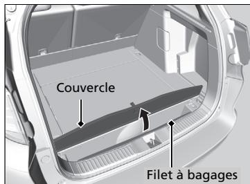
Le filet à bagages se trouve dans le compartiment sous le plancher arrière. Ouvrir le couvercle pour extraire le filet.
