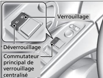
Appuyer sur le commutateur principal de verrouillage centralisé des portes comme indiqué pour verrouiller ou déverrouiller toutes les portes et le hayon.
