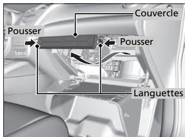
5. Enfoncer les languettes aux extrémités du couvercle de boîtier de filtre et le déposer.
