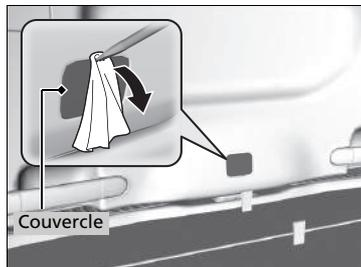
1. Utiliser un tournevis à lame plate pour déposer le cache à l'arrière du hayon.
