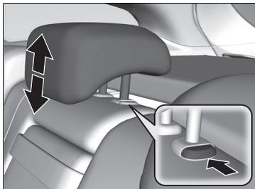
Un passager assis à l'arrière doit régler la hauteur de son appuie-tête avant le démarrage du véhicule.
