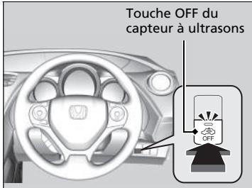
Pour désactiver le système de capteurs à ultrasons, appuyer sur la touche OFF du capteur à ultrasons après avoir retiré la clé du contacteur d'allumage, ou avec la clé en position ACCESSOIRES **1** ou ANTIVOL **0**\*1.
