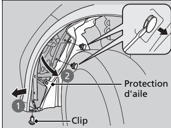
1. Tourner le volant en butée dans le sens opposé au feu à remplacer.
