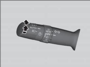
La commande d'éclairage automatique peut être utilisée lorsque le contacteur d'allumage est sur MARCHE
