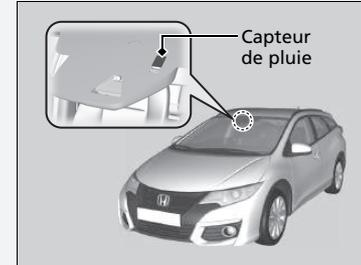
Ne pas mettre le levier d'essuie-glace en position **AUTO** pour laver le pare-brise ou passer dans une station de lavage. Avec le levier d'essuie-glace dans la position **AUTO** et le contacteur d'allumage sur MARCHE [II]<sup>\*1</sup>, le détecteur de pluie peut déclencher le fonctionnement automatique des essuie-glaces.
