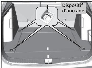
Les ancrages de fixation sur le plancher du compartiment à bagages peuvent être utilisés pour installer un filet de fixation pour les bagages.
