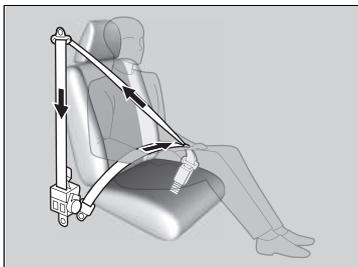
Les sièges avant sont équipés de tendeurs automatiques de ceinture de sécurité en vue de renforcer la sécurité des passagers avant.
