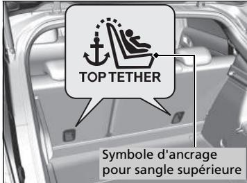
4. Relever l'appuie-tête au maximum, puis passer la sangle d'ancrage entre les tiges de l'appuie-tête et engager son crochet sur l'ancrage. S'assurer que la sangle n'est pas vrillée.
