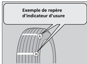
L'indicateur d'usure dans la rainure est enfoncé de 1,6 mm par rapport à la surface du pneumatique. Si l'usure de la bande de roulement est telle que l'indicateur se voit, remplacer le pneumatique. **Des pneumatiques usés présentent une adhérence réduite sur routes mouillées.**
