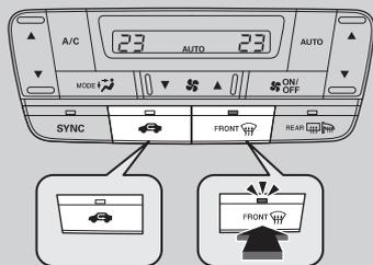
Une pression sur la touche
