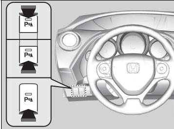
Lorsque le contacteur d'allumage est sur MARCHE **[II]**\*1, appuyer sur le bouton du système de capteurs de stationnement pour activer ou désactiver le système. Le témoin du bouton s'allume lorsque le système est activé.
