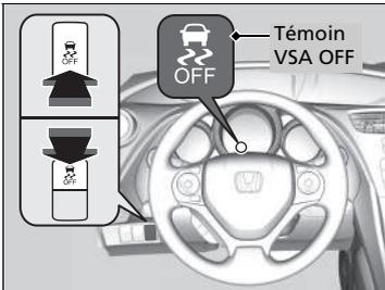
Ce bouton se trouve sur le panneau de commandes côté conducteur. Pour activer et désactiver le système VSA, appuyer sur le bouton et le maintenir enfoncé jusqu'à ce qu'un signal sonore retentisse.
