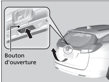
Lorsque toutes les portes sont déverrouillées ou lorsque le bouton de déverrouillage du hayon situé sur la télécommande est pressé, le hayon est déverrouillé. Appuyer sur le bouton d'ouverture du hayon et soulever le hayon pour l'ouvrir.
