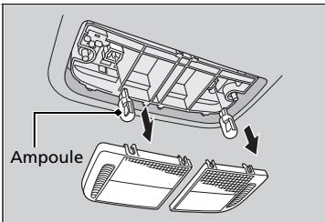
3. Déposer l'ampoule à remplacer et insérer la neuve.
