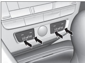
Le témoin du réglage s'allume lorsque le chauffage de siège est activé. Appuyer brièvement sur le bouton du côté opposé pour désactiver le réchauffeur. Le témoin s'éteint.
