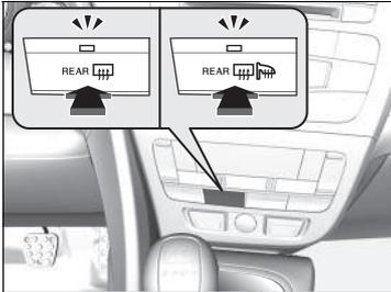
Le désembueur arrière et les rétroviseurs extérieurs chauffants se désactivent automatiquement au bout de 10 à 30 minutes en fonction de la température extérieure.
