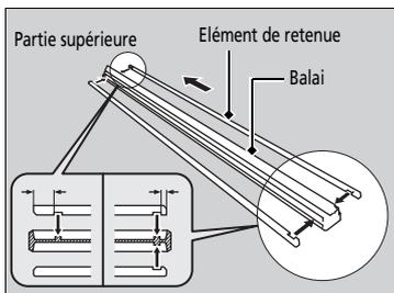
5. Retirer les éléments de retenue du balai en caoutchouc déposé et le monter sur un balai en caoutchouc neuf.
