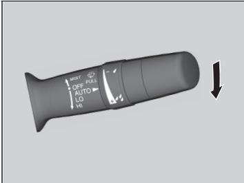
Lorsqu'on abaisse le levier sur **AUTO**, les essuie-glaces effectuent un balayage ou passent en mode automatique.
