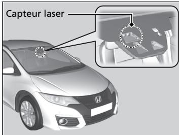
Le système actif de freinage d'urgence en ville, capteur laser compris, se situe derrière le rétroviseur.
