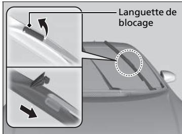
2. Placer un chiffon sur le bord de la languette de blocage. Soulever la languette de blocage à l'aide d'un tournevis à tête plate.
