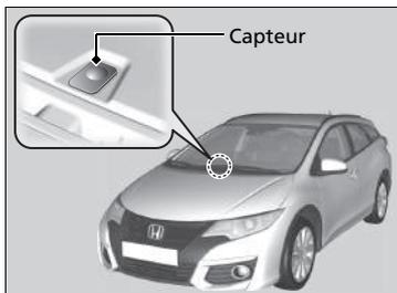
Le système de climatisation automatique est équipé de capteurs. Ne pas couvrir les capteurs ni répandre de liquide dessus.
