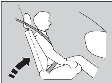
Régler le dossier du siège conducteur à une position confortable et bien droite, tout en laissant suffisamment d'espace entre le thorax et le couvremoyeu du volant de direction.
