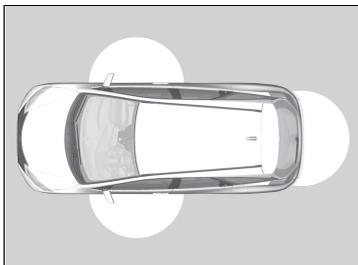
Lorsqu'on porte sur soi la télécommande d'accès sans clé, il est possible de verrouiller/déverrouiller les portes et d'ouvrir le hayon.
