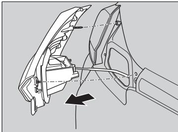
3. Tirer sur l'ensemble d'éclairage pour le dégager par l'arrière du véhicule et le déposer.
