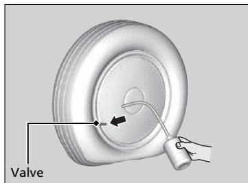
6. Visser la tubulure de remplissage sur la valve du pneu.
