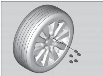
1. Déposer les boulons de roue et le pneu crevé.
