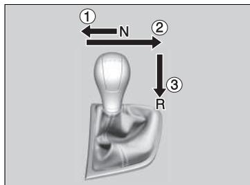
1. Enfoncer la pédale d'embrayage, pousser le levier de vitesses complètement vers la gauche et sélectionner la position **R**.
