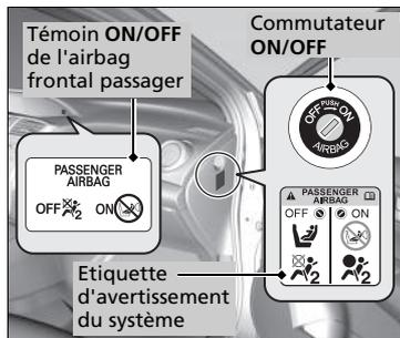
Lorsque le commutateur **ON/OFF** de l'airbag frontal passager est en position :
