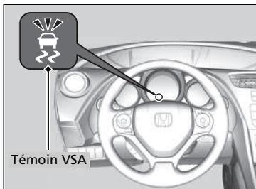
Lorsque le système VSA est activé, il est possible que le moteur ne réponde pas aux sollicitations de l'accélérateur. Un bruit en provenance du circuit hydraulique est également perceptible. Le témoin clignote.
