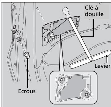
2. Retirer les écrous et la vis.
