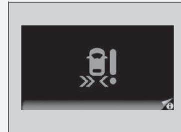
S'allume en orange s'il y a un problème avec le système. Faire contrôler le véhicule par un réparateur agréé.
