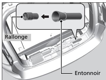
4. Sortir l'entonnoir de la boîte à outils du compartiment sous le plancher arrière.
