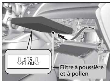
6. Déposer le filtre du boîtier.
