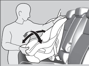
6. S'assurer que le dispositif de retenue pour enfant est fermement maintenu en le faisant jouer d'avant en arrière et d'un côté à l'autre, il ne doit présenter que peu de jeu.
