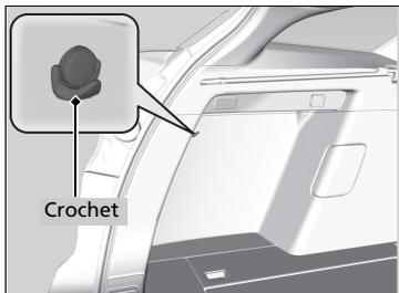
Le crochet à bagages du compartiment à bagages peut être utilisé pour suspendre une charge légère.
