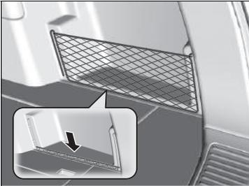
Utiliser le filet latéral du compartiment à bagages pour maintenir la charge sur le côté.
