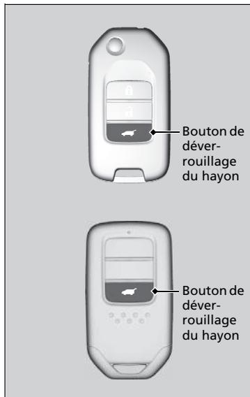
Appuyer sur le bouton de déverrouillage du hayon pour déverrouiller le hayon.
