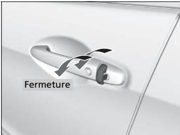
**Fermeture :** verrouiller la porte conducteur à l'aide de la clé. Dans les 10 secondes suivant le retour de la clé à sa position centrale, tourner la clé dans le sens du verrouillage et la maintenir dans cette position.
