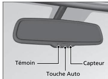
Réduit l'éblouissement causé par les phares du véhicule se trouvant derrière en conduite nocturne. Appuyer sur la touche Auto pour activer et désactiver cette fonction. Lorsque cette fonction est activée, le témoin Auto s'allume.
