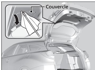
1. Faire lever sur le bord du cache à l'aide d'un tournevis à tête plate pour le déposer.
