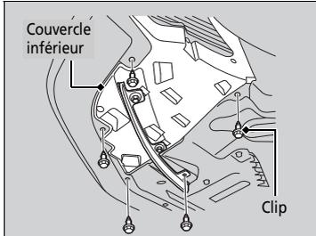
1. Déposer les clips à l'aide d'un tournevis à tête plate et abaisser le couvercle inférieur.
