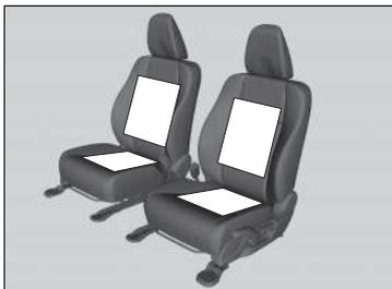
Pour pouvoir utiliser le chauffage de siège, le contacteur d'allumage doit être sur MARCHE
