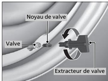
5. Dévisser le noyau de valve à l'aide de l'extracteur de valve. Ne pas placer le noyau de valve dans le sable ou la poussière.
