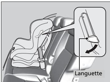
1. Placer le dispositif de retenue pour enfant sur le siège du véhicule.
