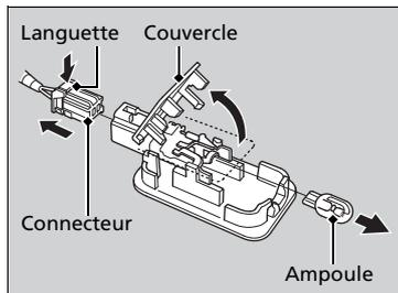
2. Pousser la languette pour déposer le connecteur.
