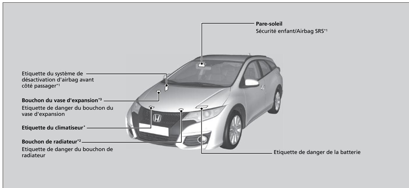
\*1 : Véhicules à conduite à gauche représentés. Pour les véhicules à conduite à droite, les emplacements des étiquettes sont symétriquement opposés.
