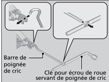
3. Soulever le véhicule à l'aide de la barre de poignée de cric et de la poignée de cric jusqu'à ce que le pneumatique ne repose plus sur le sol.
