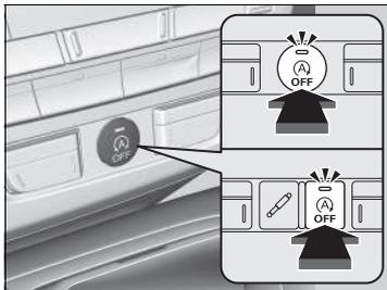
Pour désactiver le système d'arrêt automatique au ralenti, appuyer sur cette touche. Le système d'arrêt automatique au ralenti est désactivé.
