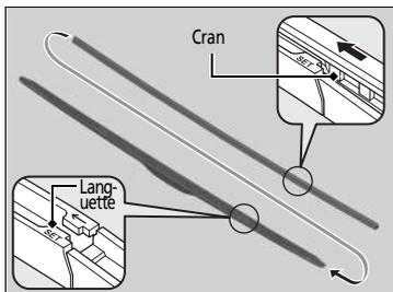
6. Poser le balai d'essuie-glace neuf en le faisant coulisser dans le support à partir de l'extrémité inférieure.
