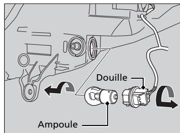
5. Tourner la douille vers la gauche et la déposer.
