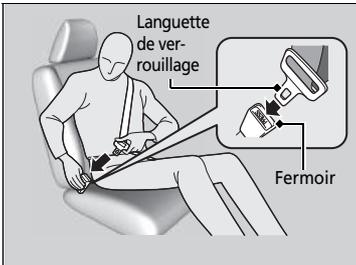
2. Introduire la languette de verrouillage dans la boucle, puis tirer légèrement sur la ceinture pour s'assurer qu'elle est correctement verrouillée.
