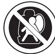
Se pencher par la porte avant peut entraîner des blessures graves voire mortelles en cas de déploiement de l'airbag latéral.
