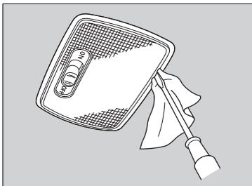
1. Faire levier sur le bord du cache à l'aide d'un tournevis à lame plate pour déposer le cache.
