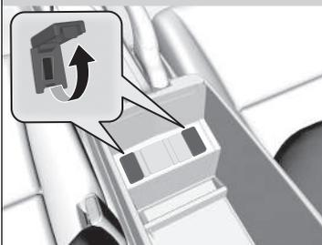
Brancher le câble Dock Connector ou la clé USB au port USB.
