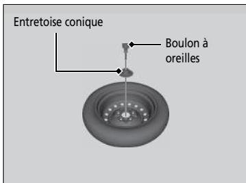
8. Dévisser le boulon à oreilles et déposer l'entretoise conique, Déposer la roue de secours.
