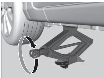
1. Placer le cric sous le point de levage le plus proche de la roue à changer.
