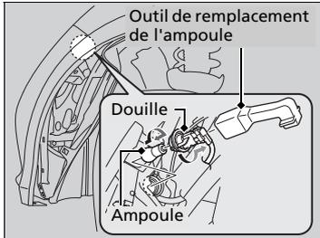
3. Tourner la douille vers la gauche et la déposer.
