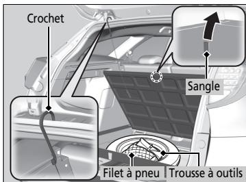
4. Tirer sur la sangle et ouvrir le cache de plancher du compartiment à bagages.
