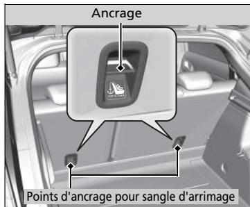
Un point d'ancrage est prévu derrière chaque place assise arrière extérieure. Sur un dispositif de retenue pour enfant fixé par la ceinture de sécurité et doté d'un point d'arrimage, celui-ci peut être utilisé pour bénéficier d'un niveau de sécurité accru.
