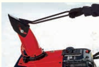
Handmatige uitworpinstelling op HS 750 EMA
