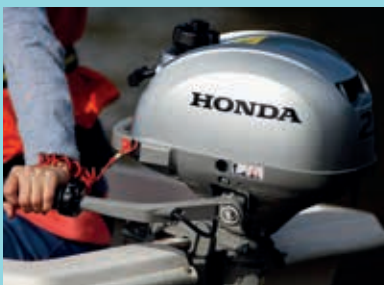
De BF2.3 is standaard uitgerust met centrifugale koppelingen voor beter comfort.
